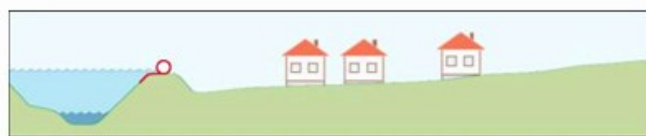
Podwyższenie istniejących wałów przeciwpowodziowych
